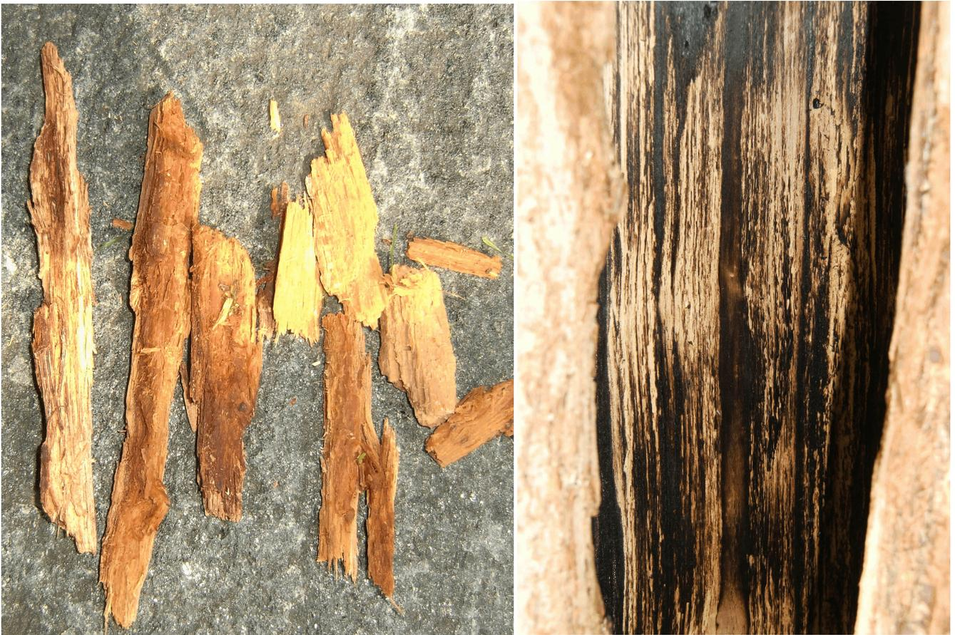
wurde mittels großer Bohrer von Moder und Schmutz befreit und schließlich mit einem Industrie-Staubsauger gereinigt. Nach zwei Wochen bei heißem Sommerwetter war das Holz trocken. Nun wurde das gesamte Innere des Stamms mit einem Propangas-Brenner gebläht. Die Reste des Moders, gut getrocknet, brennen leicht weg, während das gesunde Holz praktisch nicht angegriffen wird. So wird der Pilz eliminiert.
